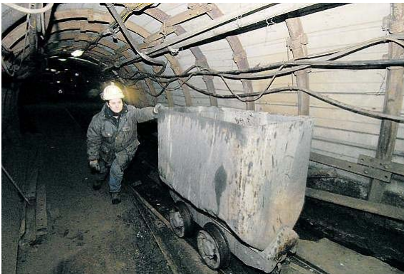
Vagoneta a tracción humana en una mina de carbón, sólo mejorada por la cinta transportadora, pero no por los neumáticos
