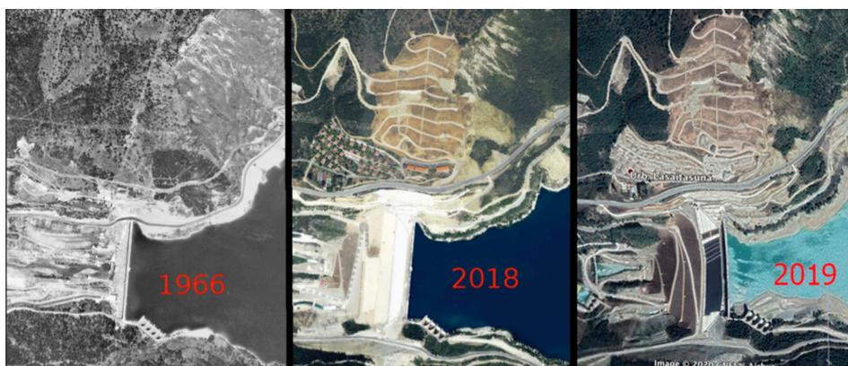
**Figura 3a.** Dimensión de la evolución de la ladera del embalse de Yesa tras los deslizamientos y las obras de contención, que afectan a las urbanizaciones, carreteras y presa de Yesa<sup>2</sup>. Fuente. Asoc. Río Aragón
